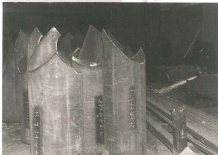
شکل ۳: تصویری از لوله های برشکاری شده گره های سبد
